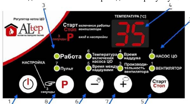
Рисунок 4 – Зовнішній вигляд передньої панелі контролера
