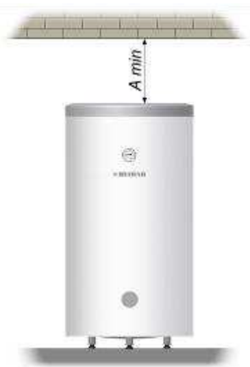
Рис. 4 Минимальное расстояние для обслуживания магниевого анода
