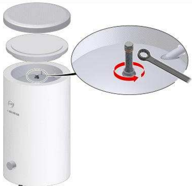
Рис. 8 Замена магниевого анода
