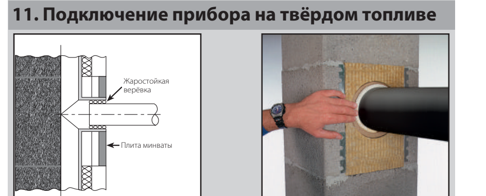
Необходимо оставить должный зазор. Этот зазор должен быть заполнен эласт. материалом (напр. жаростойкой ветовью).
