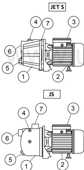
При работе насос с помощью вращающегося рабочего колеса и внутреннего эжектора всасывает воду из источника и нагнетает ее под давлением в напорную магистраль. На корпусе насоса расположена идентификационная табличка, на которой указаны следующие данные: Модель, серийный номер (первые четыре цифры серийного номера обозначают дату изготовления в формате ММГГ).
