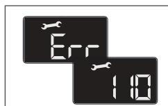
**Защитное отключение из-за низкого давления воды**
