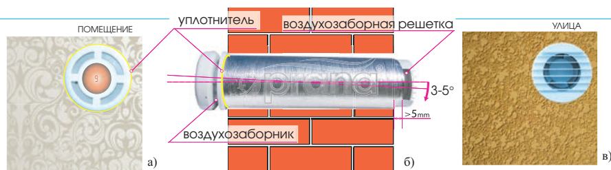
Рис. 3. Схема установки «PRANA-150», «PRANA-200G», «PRANA-200C» в стене:
