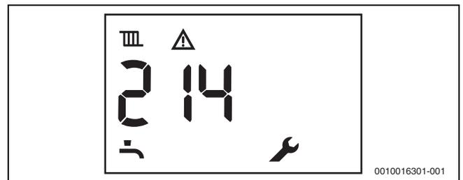
Рис. 6 Пример кода неисправности
