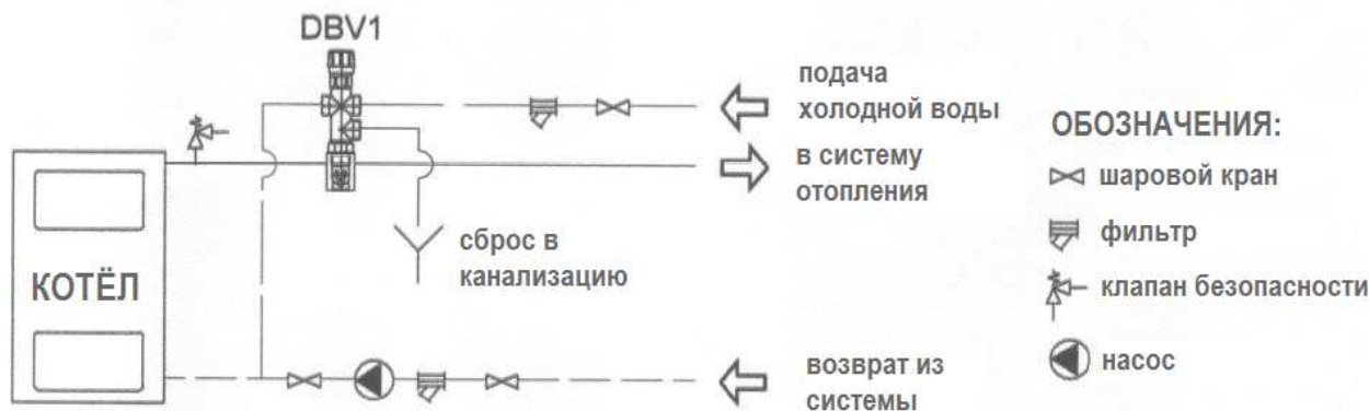
Рис.3 Схема системы с двухходовым клапаном безопасности DBV1.
