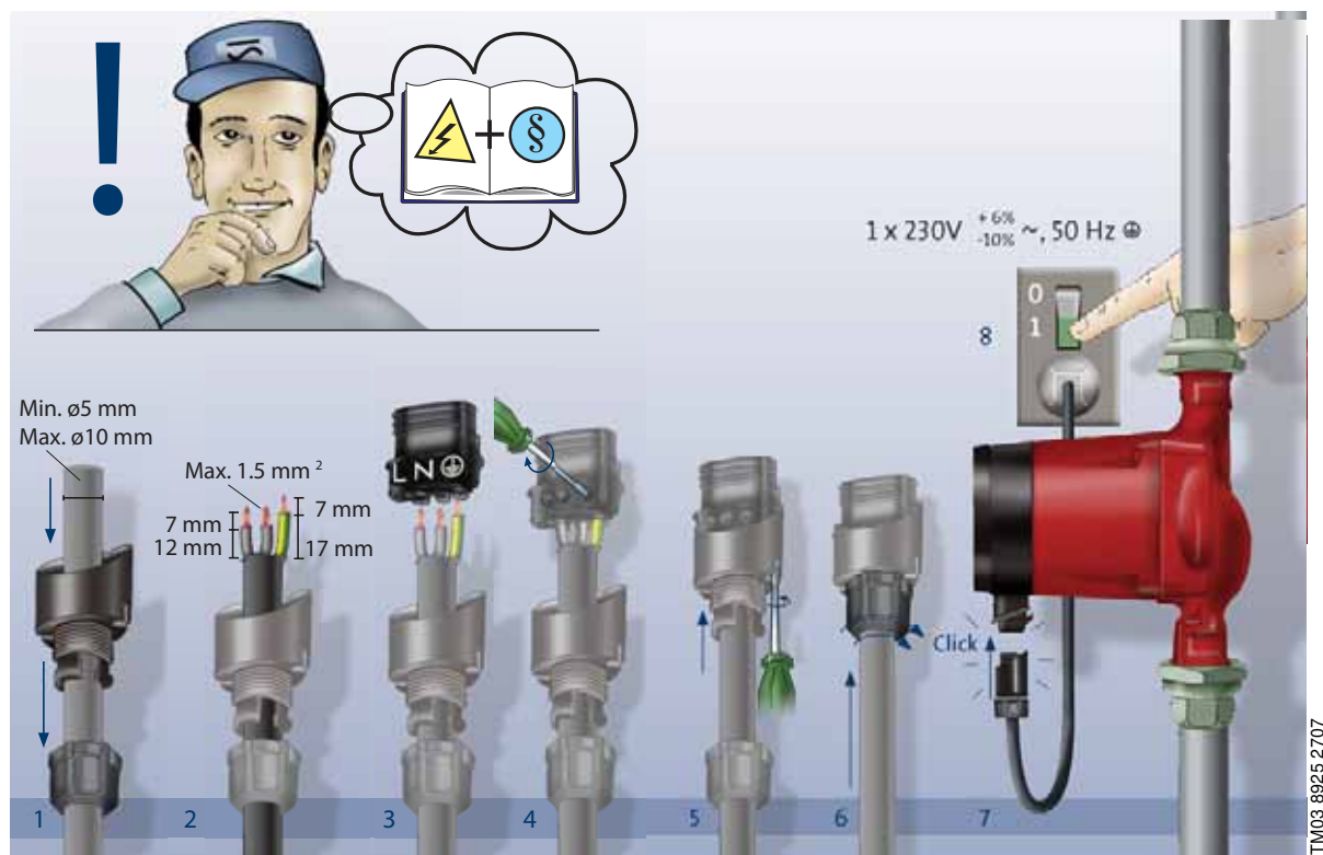
Рис. 6 Подключение электрооборудования
