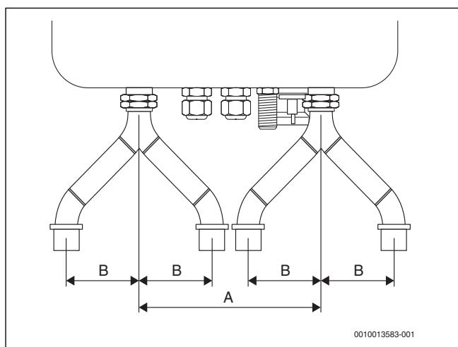
Obr. 2 Úprava potrebného odstupu
