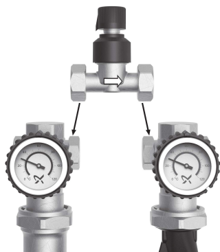
Рис. 4 Монтаж байпасного клапана
