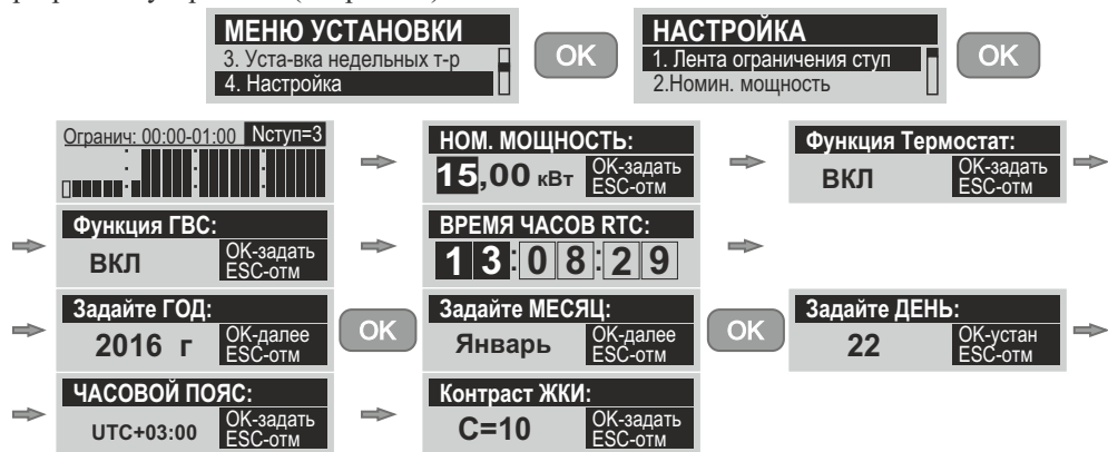
Рисунок 31. Настройка внутренних параметров и установок.
