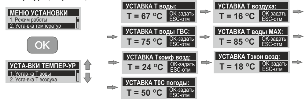
Рисунок 29. Установка температурных параметров.
