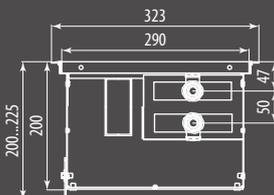
Разрез Ntherm 300.200 с U-образным бортом
