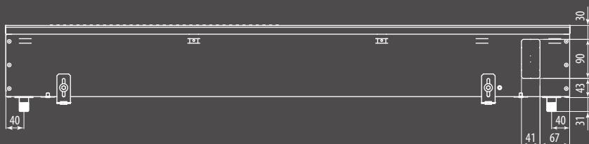
Вид сбоку конвектора Ntherm 230.150 с роликовой решеткой с U-образным бортом, с дренажом
