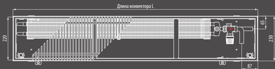
Вид сверху конвектора Ntherm 230.150 с роликовой решеткой с U-образным бортом, с дренажом
