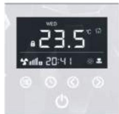
Регулирование температуры в помещении при микропроцессорной схеме регулирования осуществляется программируемыми регуляторами типа 703201 (черного цвета) или 703202 (белого цвета) через сенсорный экран путем плавного изменения скорости вращения вентиляторов и управлением термоэлектрическим сервоприводом линии нагрева. Конвектор можно подключать к любым инженерным системам, в том числе «умный дом» по протоколу ModBus через RS485.
