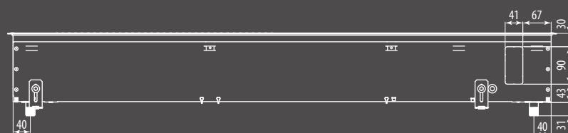
Вид сбоку конвектора Qtherm 370.150 с F-образным бортом, с дренажом
