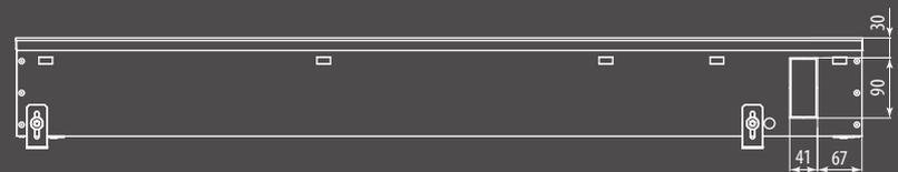
Вид сбоку конвектора Qtherm 370.150 с U-образным бортом
