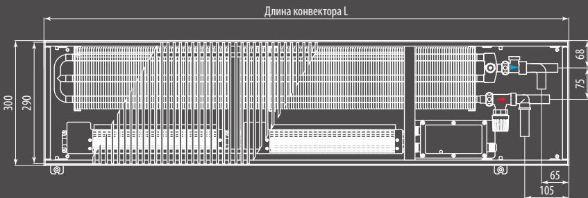
Вид сверху конвектора Qtherm 300.75 с роликовой решеткой с U-образным бортом
