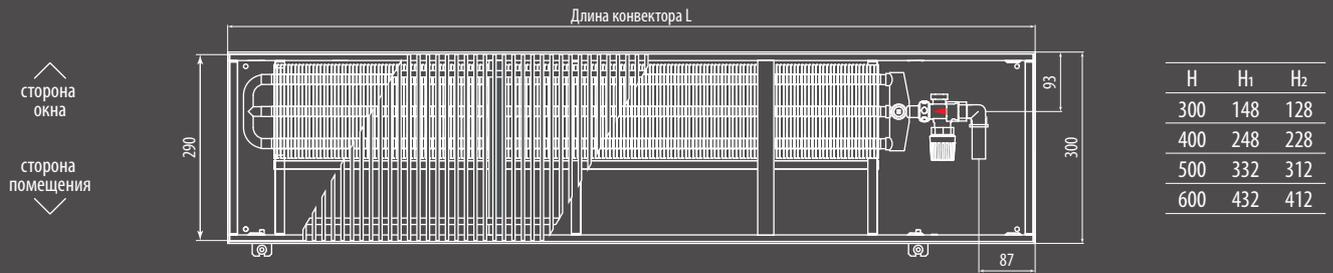
Вид сверху конвектора Ntherm Maxi 300 с роликовой решеткой с U-образным бортом
