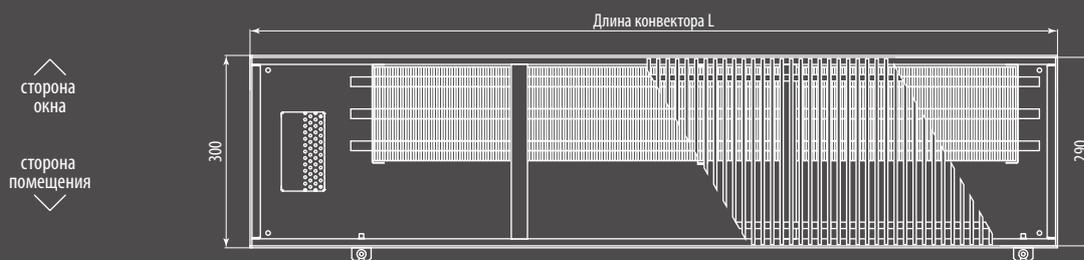
Вид сверху конвектора Ntherm Electro 300 с роликовой решеткой с U-образным бортом
