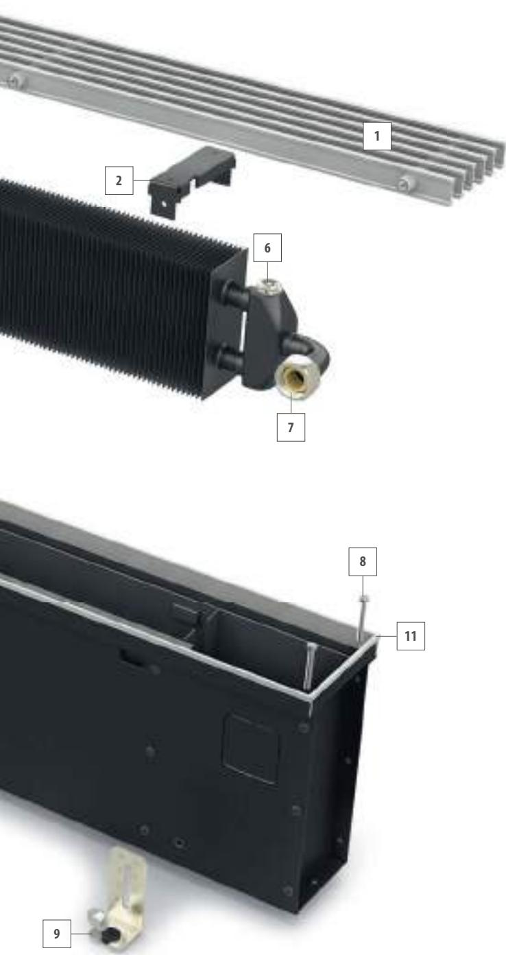
**1** Решетка алюминиевая роликового, либо линейного исполнения, анодированная, окрашенная в любой цвет по RAL, с нанесением фактур дерева, мрамора, гранита или из полированной нержавеющей стали.
