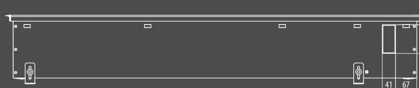
Вид сбоку конвектора Ntherm 300.200 с роликовой решеткой с U-образным бортом
