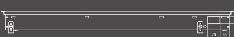
Вид сбоку конвектора Qtherm 300.110 с F-образным бортом
