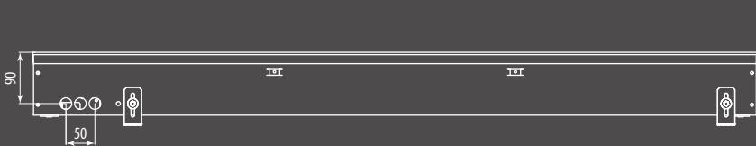
Вид сверху конвектора Ntherm Electro 370 с U-образным бортом
