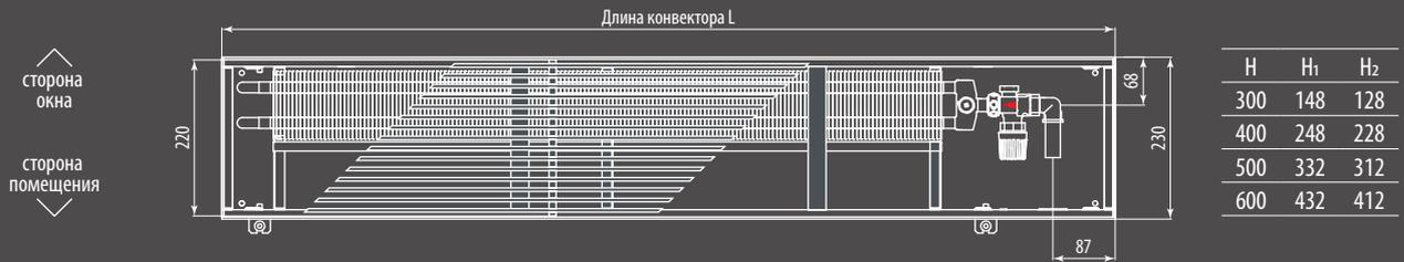
Вид сверху конвектора Ntherm Maxi 230 с роликовой решеткой с U-образным бортом
