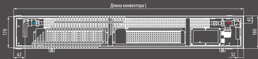
Вид сверху конвектора Qtherm 180.110 с роликовой решеткой с U-образным бортом, с дренажом
