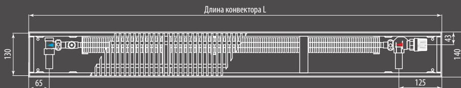
Вид сверху конвектора Ntherm 140.90 с роликовой решеткой с U-образным бортом
