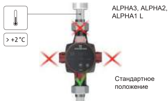
Рис. 17 Возможное положение блока управления для системы отопления
