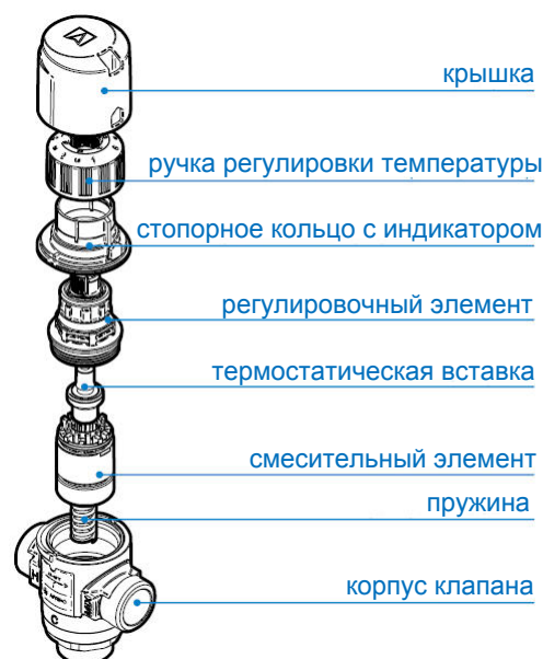
Рис. 2: Конструкция клапана ATM
