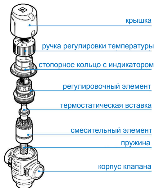
Рис. 2: Конструкция клапана ATM
