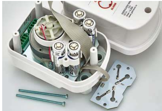
Фото 31. Контактная площадка снята, батарейки могут быть заменены
