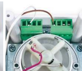
Фото 11. Подключение датчика к электроприводу
