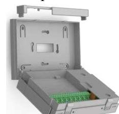
4. - установите контроллер на монтажной панели и оденьте верхнюю фиксирующую планку
