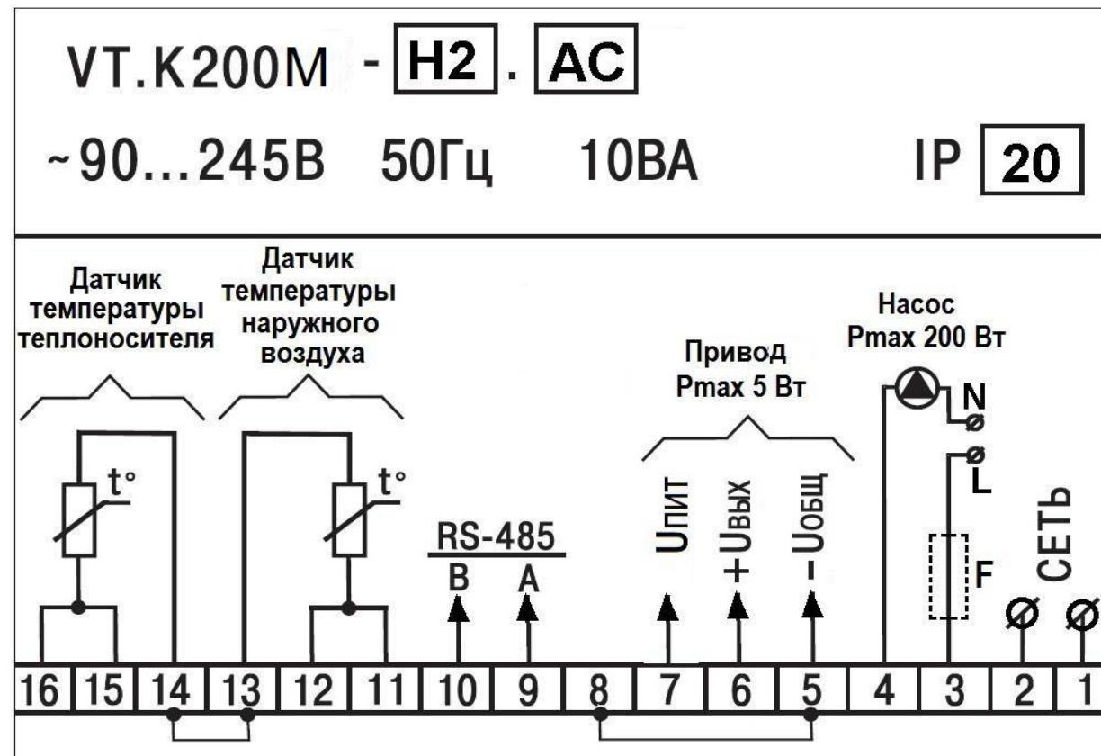
5.3.9. Подключение сервопривода **VT.TE 3061** осуществляется в следующем порядке: клемма 7 –чёрный провод; клемма 6 –красный провод; клемма 5 – синий провод.
