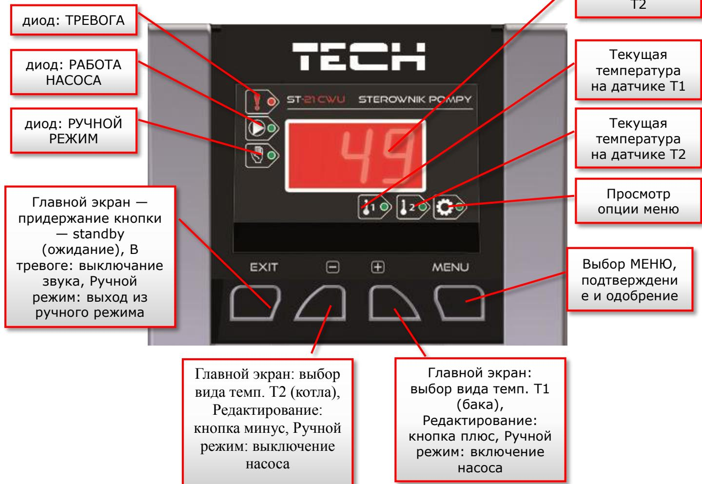
Регулятор ST-21CWU это универсальный контроллер оснащен двумя датчиками температуры. Регулятор используется для управления циркуляционным насосом.
