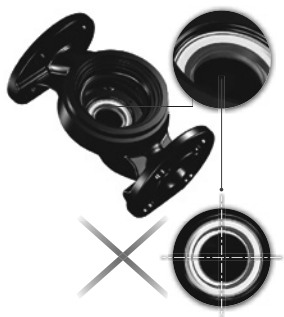
Рис. 16 Неправильно выровненная система уплотнений
