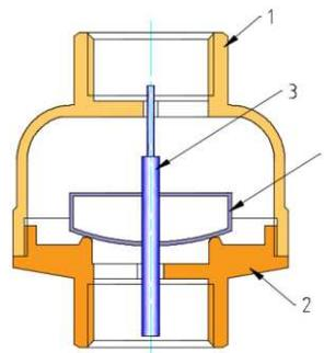
Внутри корпуса, выполненного из двух латунных (CW617N) деталей 1 и 2 свободно перемещается по направляющим шток 3, к которому приварен поплавок 4. Шток и поплавок выполнены из нержавеющей стали AISI 304. В обычном положении поплавок находится в верхней позиции, не препятствуя естественной циркуляции теплоносителя. При включении циркуляционного насоса, расположенного на обводящем участке (байпасае), клапан закрывается, включая в работу обводящий участок.
