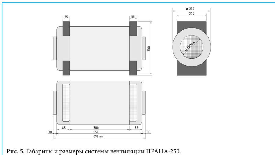
Рис. 5. Габариты и размеры системы вентиляции ПРАНА-250.
