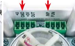
Фото 13. Клеммы подключения проводных датчиков — INP, GND
