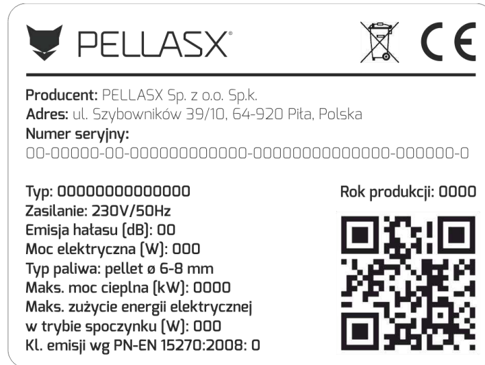
Рис. 3. Образец заводской таблички горелки.
