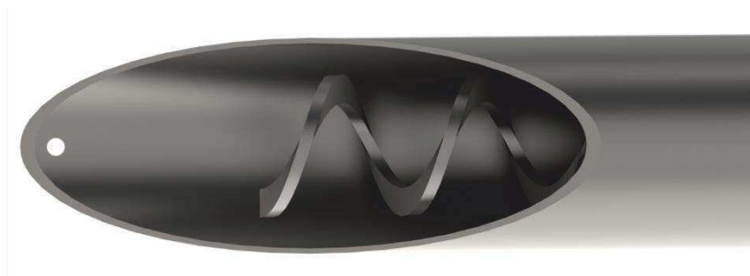
Рис.6. Монтаж спирали питателя.
