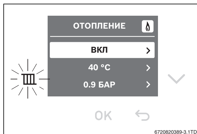
Рис. 33 Меню температуры котла
