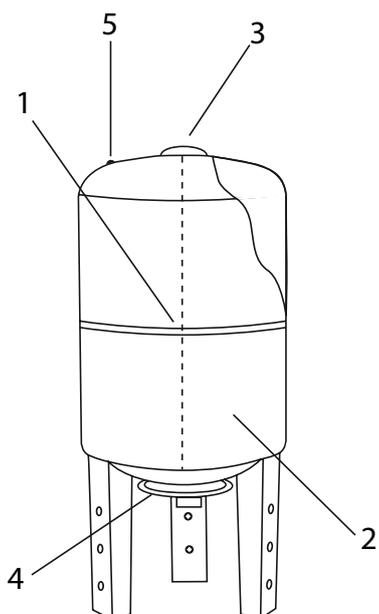
1. Корпус на ножках – сварной, окрашенный порошковой краской с последующим оплавлением, сосуд имеющий контрфланец.
