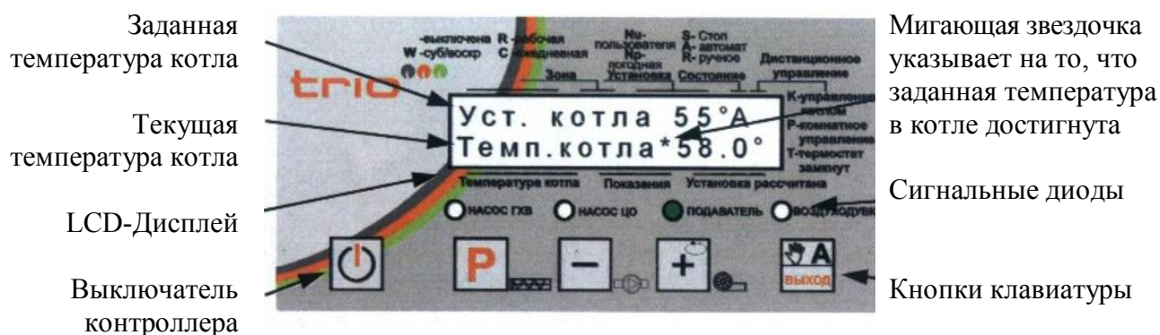
Рисунок 2 - Внешний вид передней панели контроллера
