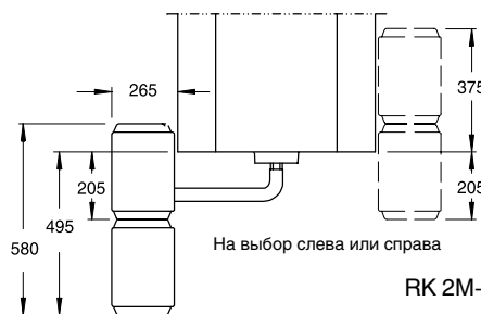
1) Максимальная высота с баком под котлом - 1,74 м 2)
