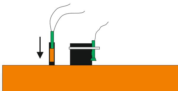
В погружную гильзу вначале опускается датчик центрального отопления, а за ним датчик термозащиты. Как вариант, допускается установка датчика термозащиты на патрубке подающего трубопровода котла (до гайки подключения), при этом, прижатие его к патрубку должно выполняться металлическим хомутом. Добавление каких-либо жидкостей в погружную гильзу **запрещено!**
