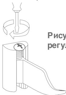
Рисунок 7. Крепление регулируемых кронштейнов
