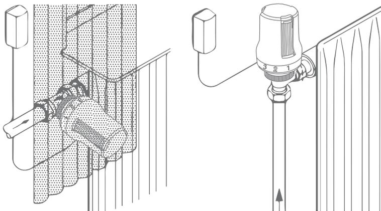
**Рисунок 10. Пример установки термостатической головки с выносным датчиком**
