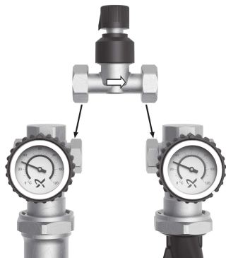
Рис. 4 Монтаж байпасного клапана
