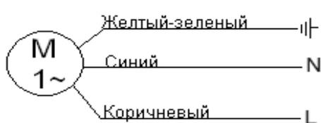
Подключение электродвигателя со встроенным пусковым конденсатором
