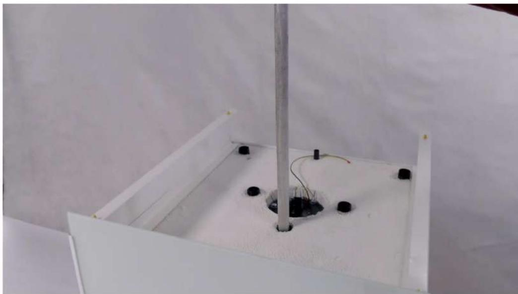
Процедура замены магниевого анода. Перед тем как заменить магниевый анод, перекройте подпитку холодной воды, спустите давление в баке и только после этого, убедившись что все порядке, выкручивайте анод. Требования по замене магниевого анода описаны в инструкции по монтажу и эксплуатации баков.
