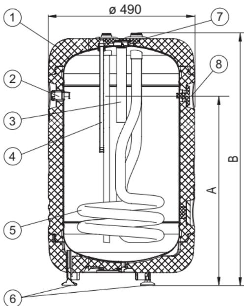
ZW- холодная вода (трубка PEX-AL-PEX)
