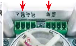
Фото 13. Клеммы подключения проводных датчиков — INP, GND
