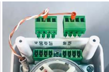
Фото 23. Подключение проводного выключателя
