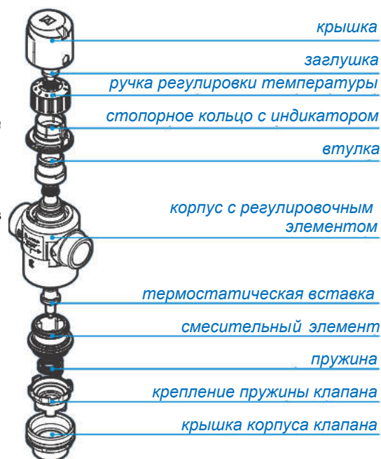
Рис. 2: Конструкция клапана ATM Kvs = 3,2 м³/ч и 4,2 м³/ч
